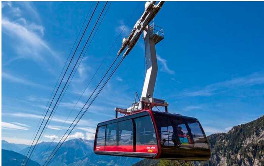
Figura 20 - Esempio di una classica funivia bifune a va e vieni. Si noti lo scartamento ridotto delle funi portanti e l'altezza della sospensione.
