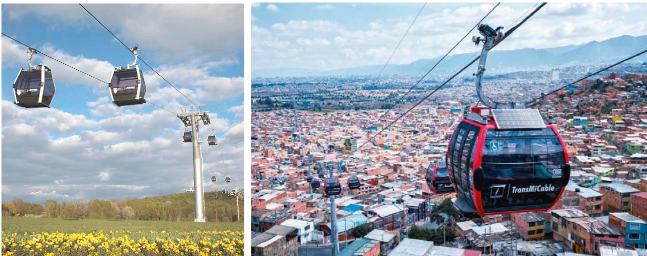
Figura 18 - Esempi di cabinovia 10 posti. Si noti la presenza di una singola fune per ramo che esplica sia la funzione di supporto e movimentazione dei veicoli.
