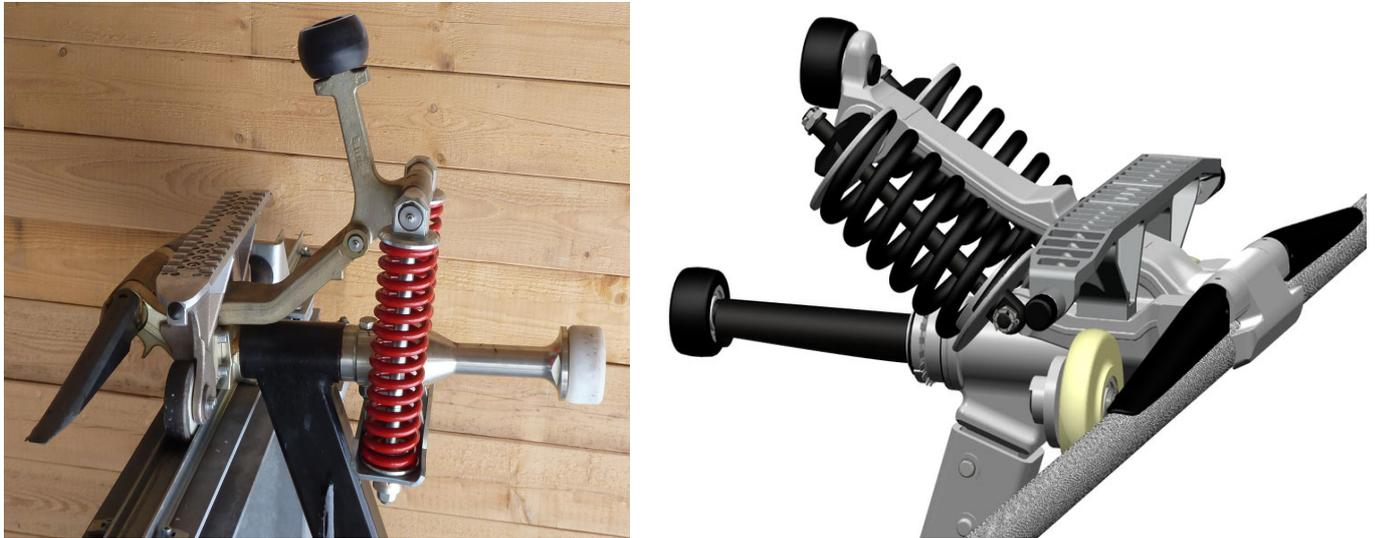
Figura 12. Tipologia di morse impiegati da diversi costruttori di cabinovie ad ammortamento temporaneo dei veicoli.
