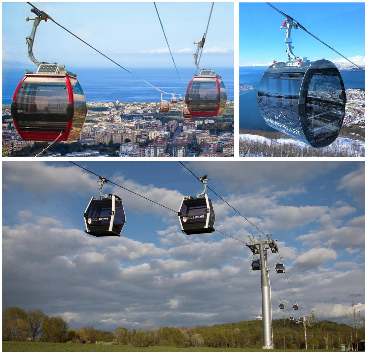
Figura 13. Due esempi di veicoli chiusi impiegati dalle principali ditte produttrici di impianti a fune in ambito urbano.
